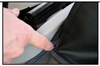
STEP 3 CONT: NEXT PULL THE ELASTIC STRAP IN-BETWEEN THE BACK SEAT AND THE TRIM PANEL.. PULL UNTIL THE VINYL COVERS THE BACK SEAT
