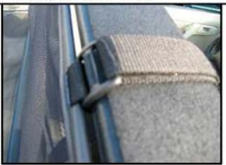
STEP 3: MOVE TO THE BACK OF THE WIND DEFLECTOR. START BY MAKING SURE THAT THE BACK OF WIND DEFLECTOR IS INSIDE THE TRIM PANEL DOWN ABOUT 2 INCHES, INSIDE THE SIDE OF THE BACK SEAT (1/4 TRIM PANEL)
