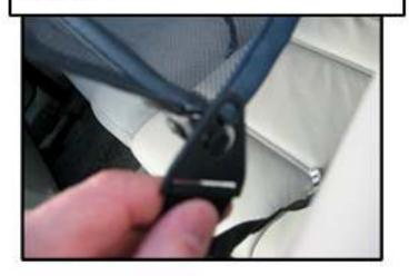
THE DOWN STRAP HOLDS THE WIND DEFLECTOR DOWN AND FORWARD
