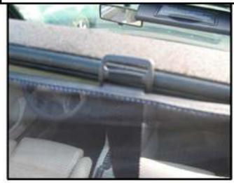
STEP 2 CONT: WRAP THE STRAP AROUND THE ROLL BAR THE STRAP THEN GOES THRU THE SLIDER
