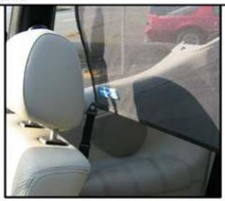
STEP 2: START BY LINING UP THE PLASTIC SLIDER UP WITH THE TOP OF THE ROLL BAR. THE STRAP WILL GO UNDER THE ROLL BAR, THEN BACK OVER TOP AND THRU THE PLASTIC SLIDER
