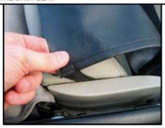
STEP 3 CONT: THE ELASTIC WILL FIT SNUGLY BETWEEN THE BACK SEAT AND THE PANEL. REPEAT ON THE OTHER SIDE
