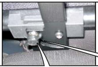
TURN THE LOCK NUT TOWARD THE DRIVERS SIDE TO TIGHTEN AND PASSENGER TO LOOSEN
