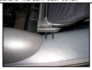
TURN THE BACK BRACKETS SO IT LOCKS INTO THE HEADREST SUPPORTS -
