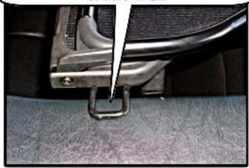
THEN ATTACH THE TWO STRAPS TO THE WIND DEFLECTOR AND PULL THE STRAPS TIGHT
