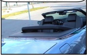
PUSH WIND DEFLECTOR BACK SO THE REAR BRACKETS TOUCH THE ROLL BAR. THE STRAPS RAP AROUND THE ROLL BAR AND ATTACH WITH A BUCKLE. PULL THE STRAPS TIGHT. REPEAT ON OTHER SIDE
