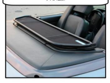
YOUR WIND DEFLECTOR FOLDS FLAT WHEN THE ROLL BAR IN ENGAGED
