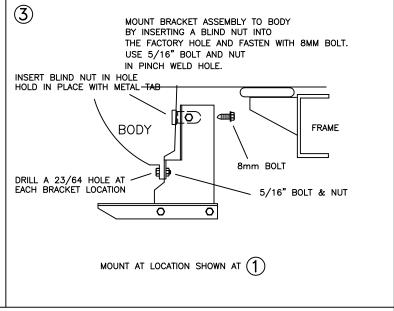
DRILLING INTO BODY AND FRAME IS REQUIRED.
