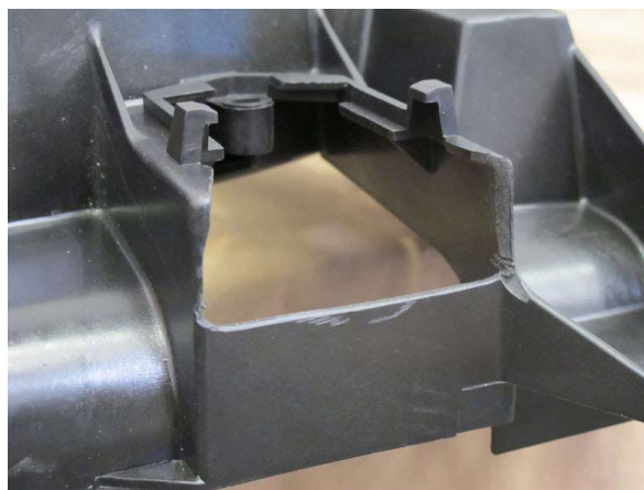
Fig. 3AI: Fan Module Mounting Location Trimming
