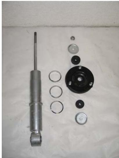
6. RE-ASSEMBLY OF THE FRONT SHOCK/SPRING
